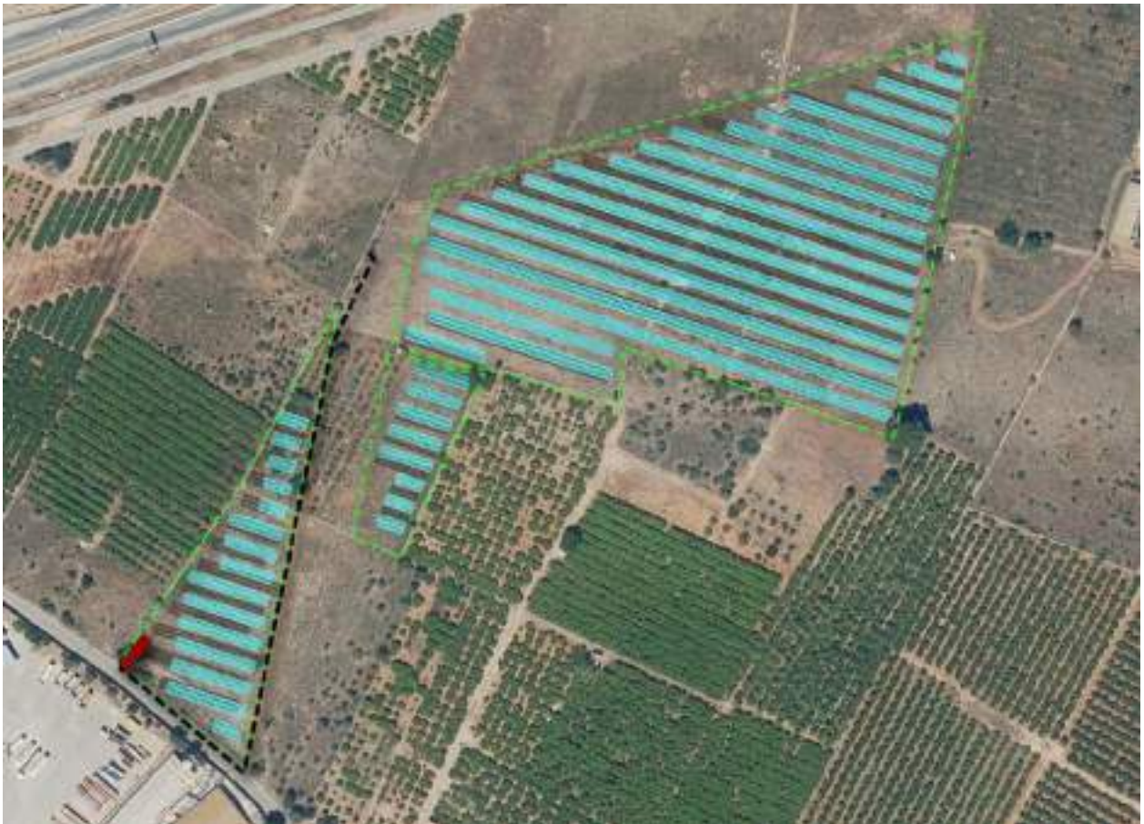
Figura 13.- Emplazamiento de la línea enterrada
