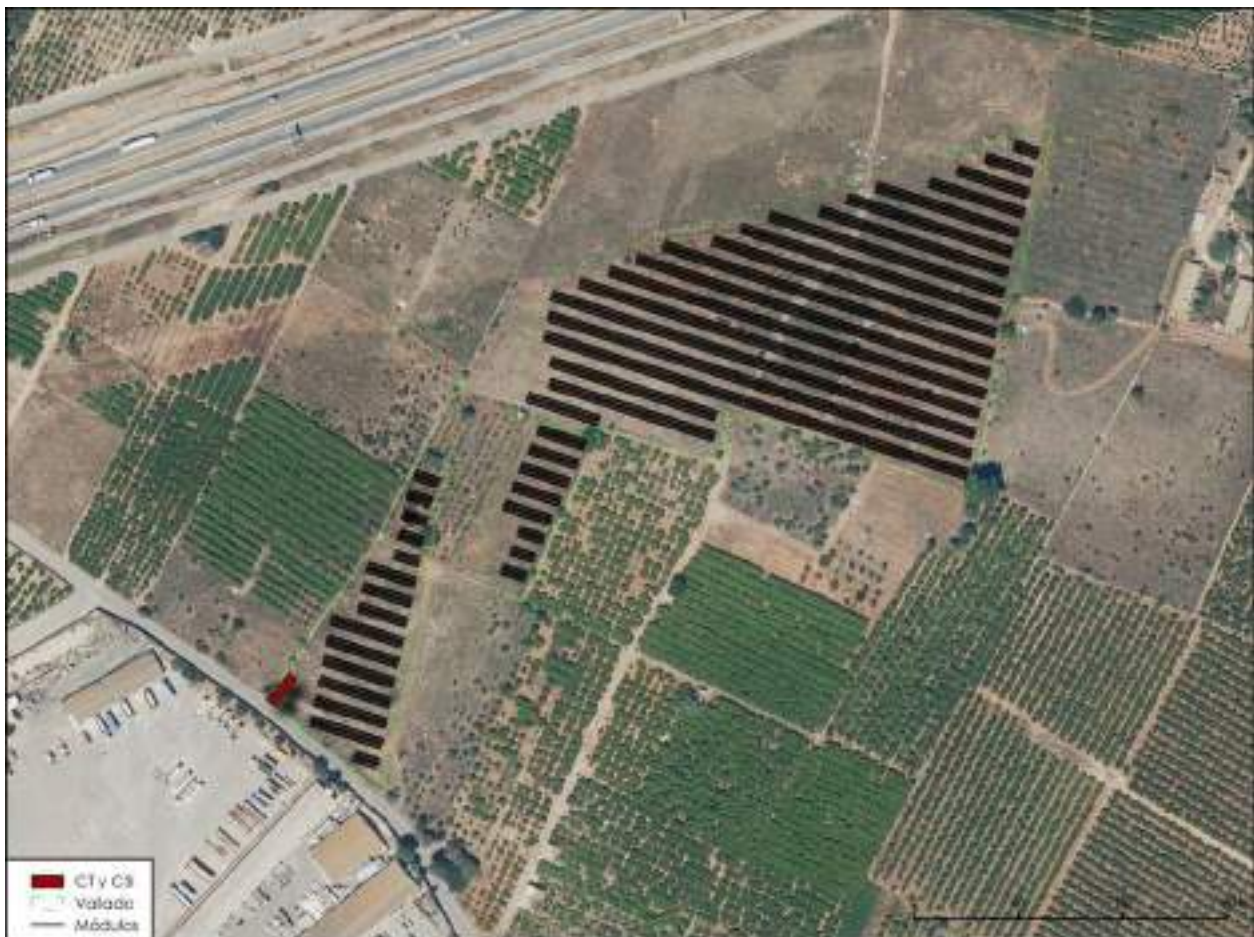
Figura 1.- Distribución de la planta
