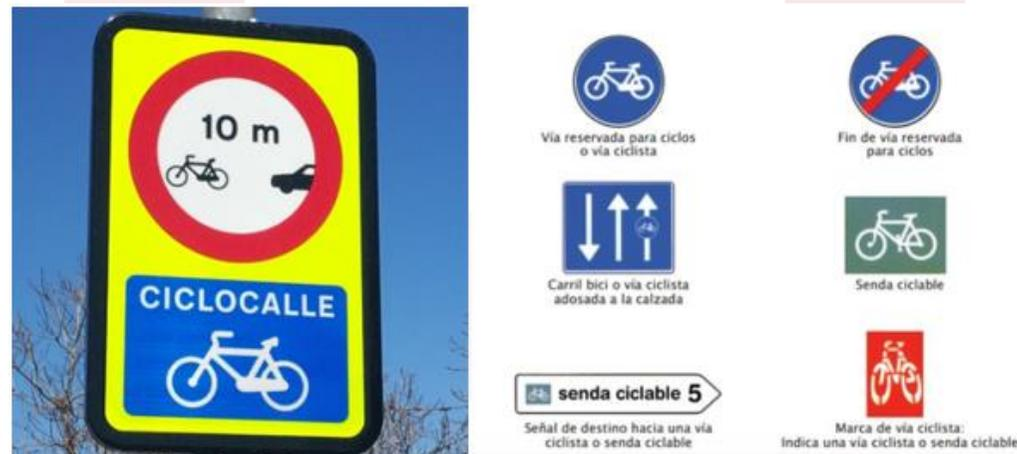
Imagen 20-3.10 Ejemplos de señalización vertical para ciclo-calle y vía segregada.
