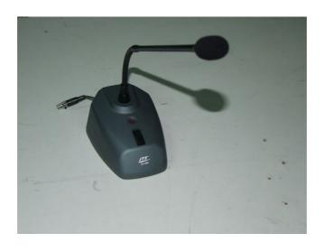
Modelo ST-850. Estos micros tienen que ser alimentados por phantom si se usan con cable, o pueden usarse como inalámbricos acoplándole a cada uno una petaca PT-920BG. No pueden usarse con pilas.
