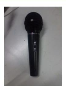
Marca Phone Star, modelo FDM; 1070, de 600 ohmios, con interruptor y conexión a cable canon
