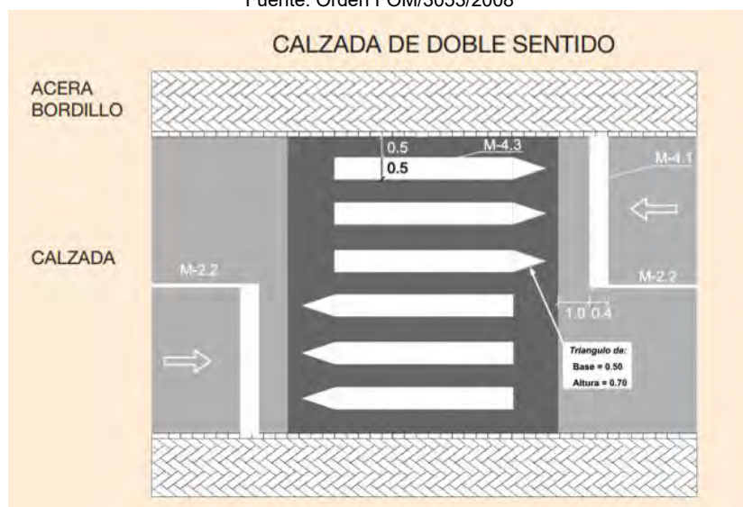
Figura 2. Reductor de velocidad trapezoidal Fuente: Orden FOM/3053/2008
