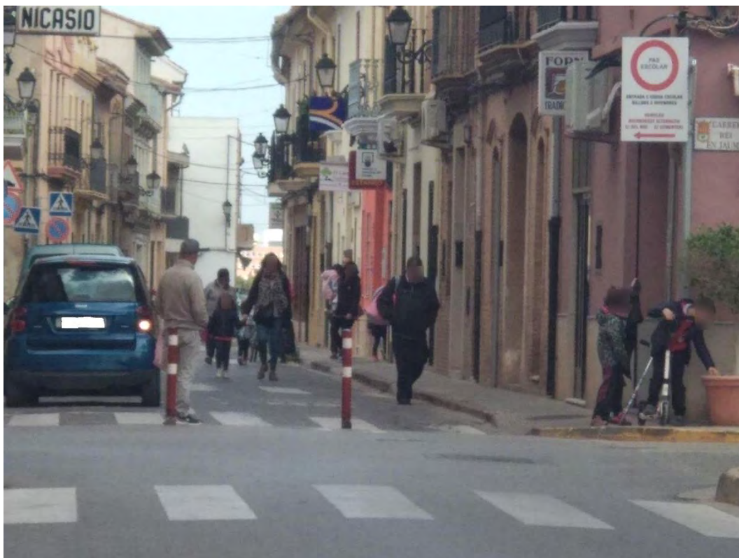
C/ Verge del Pilar, cruce con C/Rei En Jaume. Bolardos móviles para restricción de tráfico en horario escolar
