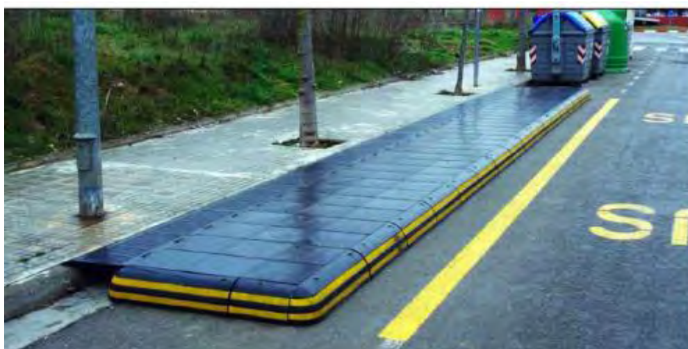
Ejemplo de plataforma a base de elementos modulares de plástico reciclado.
