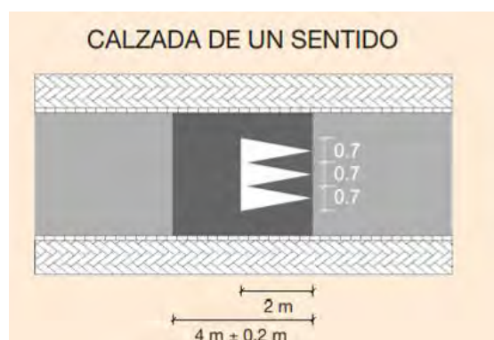
Figura 1. Reductor de velocidad tipo “lomo de asno” Fuente: Orden FOM/3053/2008
