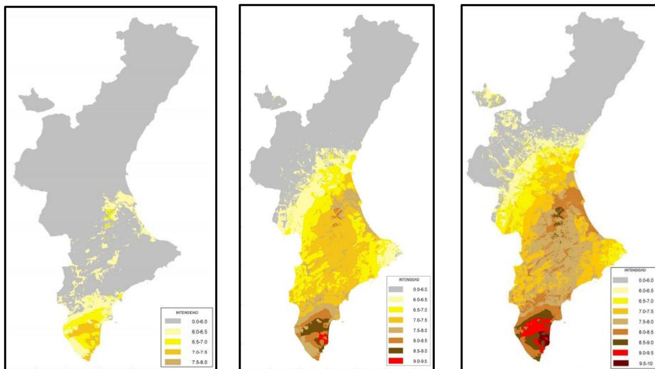
En general, se puede observar que en la comarca de la Vega Baja del Segura, a medida que se incrementa el periodo de retorno, se incrementa la intensidad del sismo esperado, y el área afectada por el mismo. La escala de intensidad utilizada, desde 1998, es la Escala Macrosísmica Europea (EMS-98).
