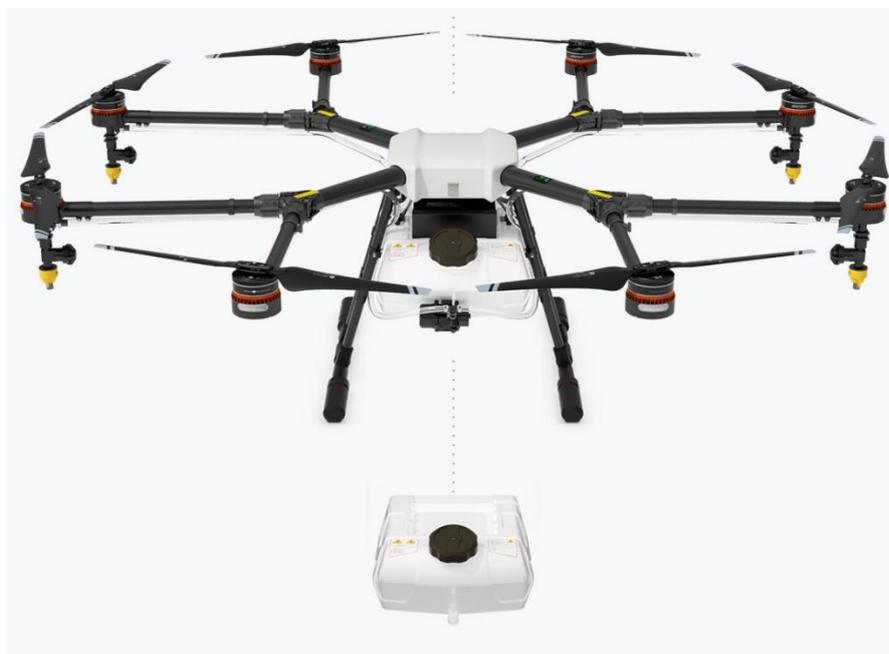
El potente sistema de propulsión del MG-1 permite a la aeronave transportar hasta 10 kg de cargas útiles líquidas, incluidos pesticidas y fertilizantes.
