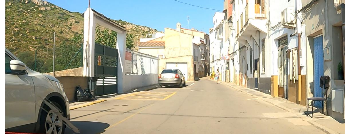
Ilustración 10. Aceras con dimensiones reducidas que obligan a los peatones a circular por la calzada. Fuente: Elaboración propia.
