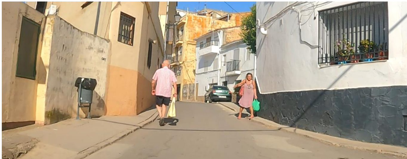
Ilustración 9. Aceras con dimensiones reducidas que obligan a los peatones a circular por la calzada. Fuente: Elaboración propia.
