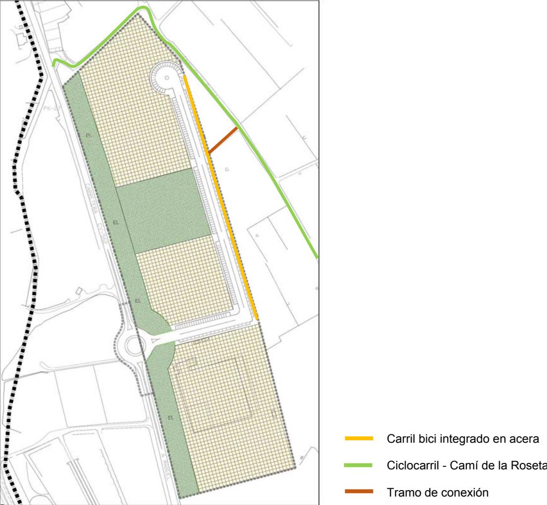
Figura 20. Conexión entre el Camí Roseta (ciclocarril) y el carril bici del futuro sector industrial.
