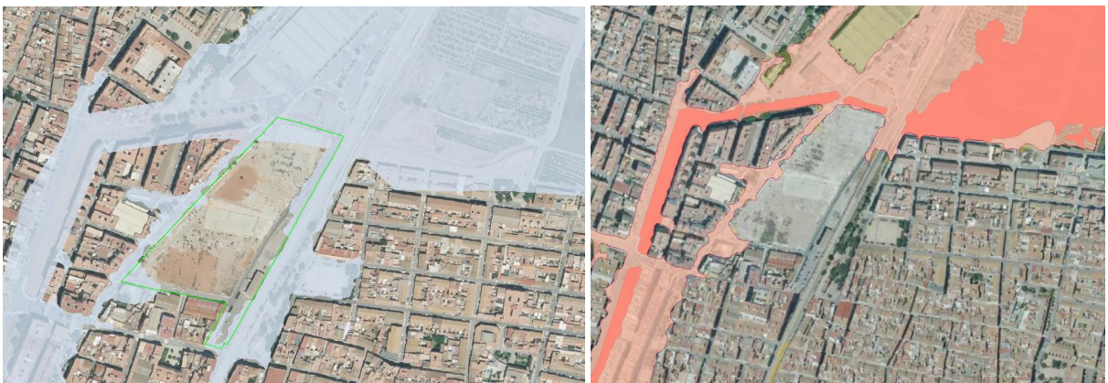
Figura 19. A la izquierda, envolvente de peligrosidad de inundación según PATRICOVA. A la derecha, zona inundable (períodos de retorno 10, 50, 100 y 500 años) según SNCZI.
