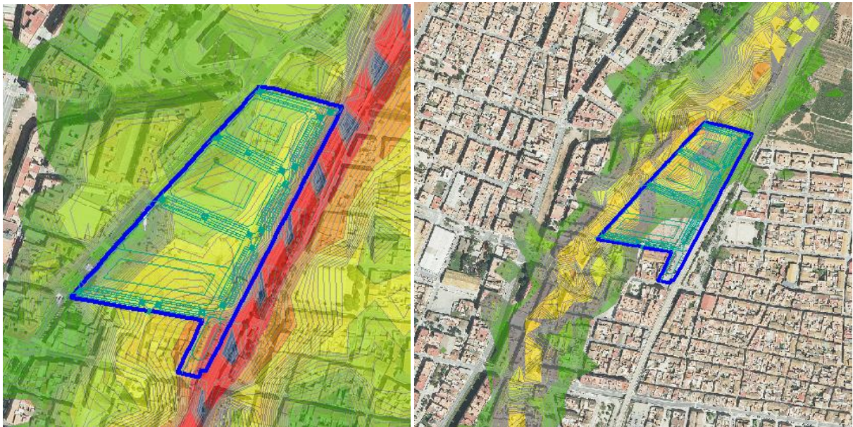
Figura 60. Izq. Emisión Ruido Ferrocarril a su paso por Puçol. Dcha. Emisión de Ruido Calle Font de Mora.
